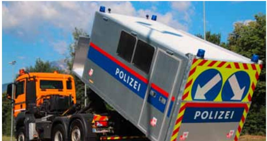
Der Container kann innerhalb kürzester Zeit aufgestellt und eingesetzt werden
