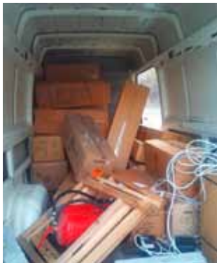
Ungesichertes Ladegut in Kleintransportern
